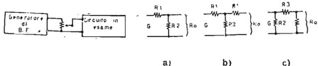
Per esempio, per avere un'attenuazione di 5 dB con una resistenza terminale di chiusura di 500 ohm (Ro), essendo uguale a 1000 ohm, quella del generatore, si ha facilmente:
