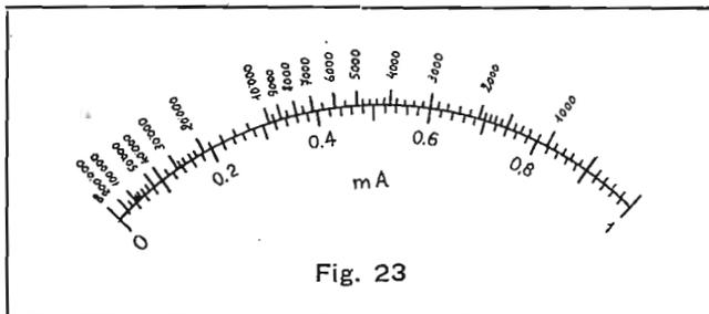
tarla alla tensione effettivamente presente nel circuito; il metodo di misura così realizzato viene denominato con *ohmmetro in serie*, ed è ormai universalmente adottato nel campo radiotecnico per il controllo rapido delle resistenze quando non è richiesta una grande precisione.
