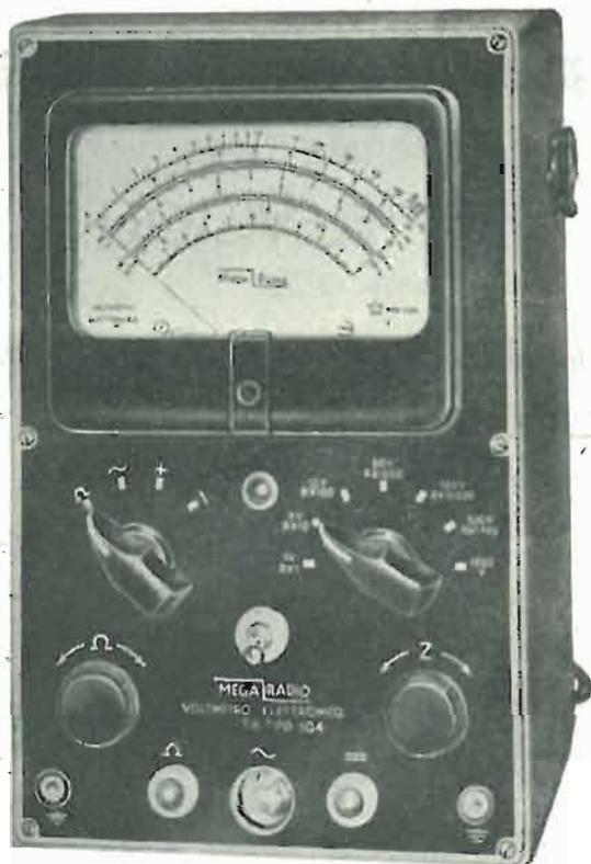
Strumento ad ampère quadrante - Portate: da 0,01 V (1 V fondo scala) a 1.000 V c.c. e c.a. in 7 portate - Sonda per la tensione alternata e R.F. con doppio diodo per l'autocompensazione - Ohmetro da frazioni di ohm a 1.000 Megaohm suddiviso in 6 portate (10 Megaohm centro scala) - scala zero centrale. Dimensioni: mm. 240x160x140 - Peso: Kg. 3,500.
