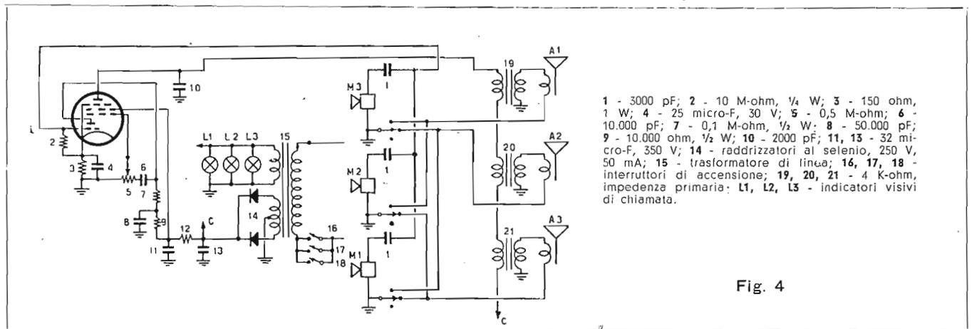
1 - 3000 pF; 2 - 10 M-ohm, 1/4 W; 3 - 150 ohm, 1 W; 4 - 25 micro-F, 30 V; 5 - 0,5 M-ohm; 6 - 10.000 pF; 7 - 0,1 M-ohm, 1/2 W; 8 - 50.000 pF; 9 - 10.000 ohm, 1/2 W; 10 - 2000 pF; 11, 13 - 32 micro-F, 350 V; 14 - raddrizzatori al selenio, 250 V, 50 mA; 15 - trasformatore di linea; 16, 17, 18 - interruttori di accensione; 19, 20, 21 - 4 K-ohm, impedenza primaria; L1, L2, L3 - indicatori visivi di chiamata.
